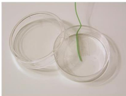
Figur 32. T-sensor fäst inuti en 35 mm petriskål
