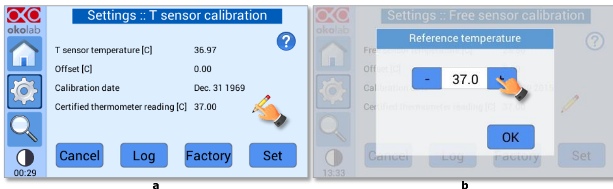
Figura 49. Cómo recalibrar el sensor T
