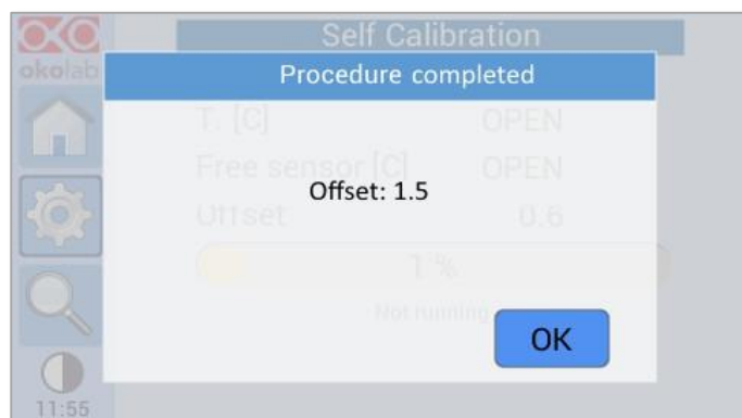
Figura 38. Esempio di procedura di auto-calibrazione riuscita
