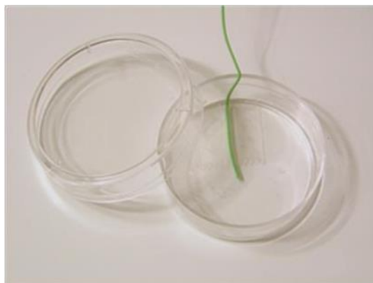
Figura 32. Sensore di Temperatura fissato all'interno di una piastra di Petri da 35 mm
