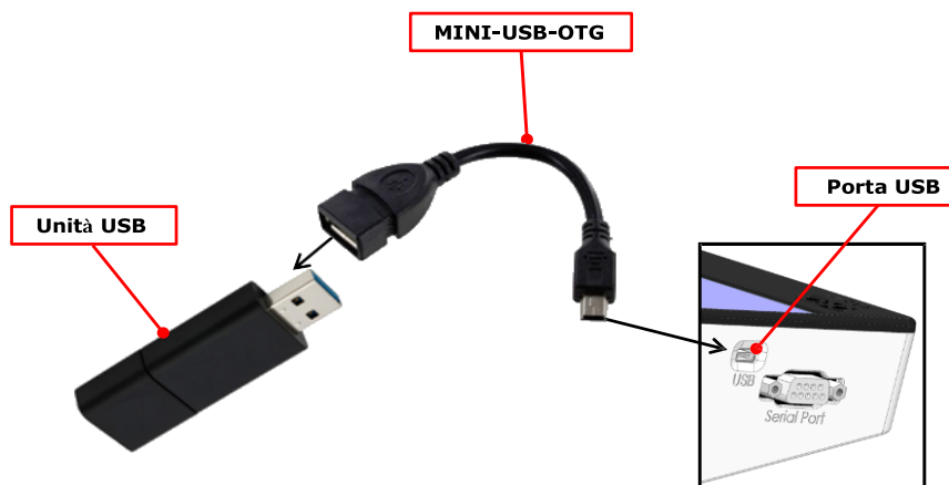
Figura 5. Connessione all'unità USB.
