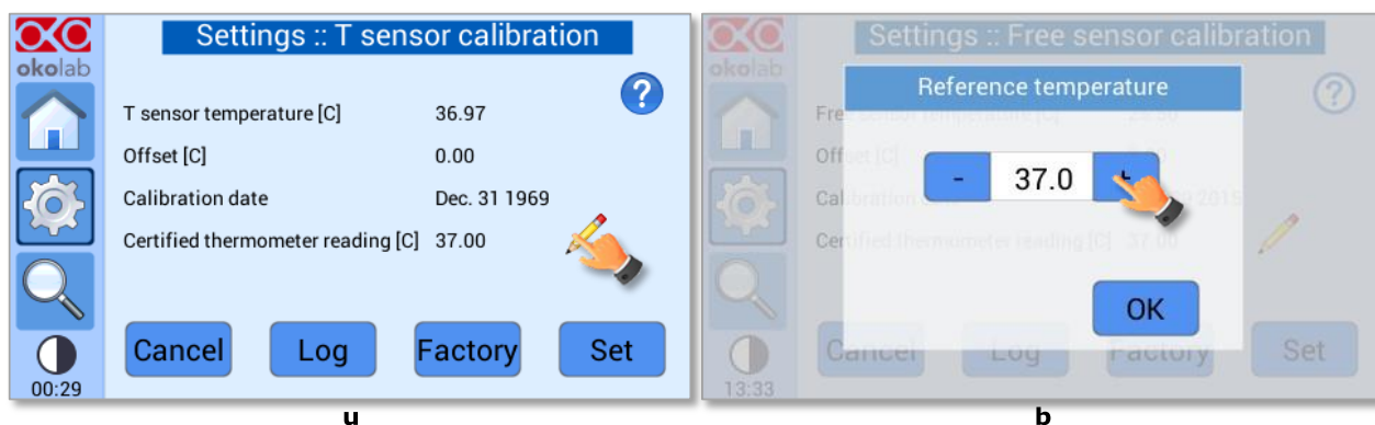
Figura 49. Come ricalibrare il sensore T
