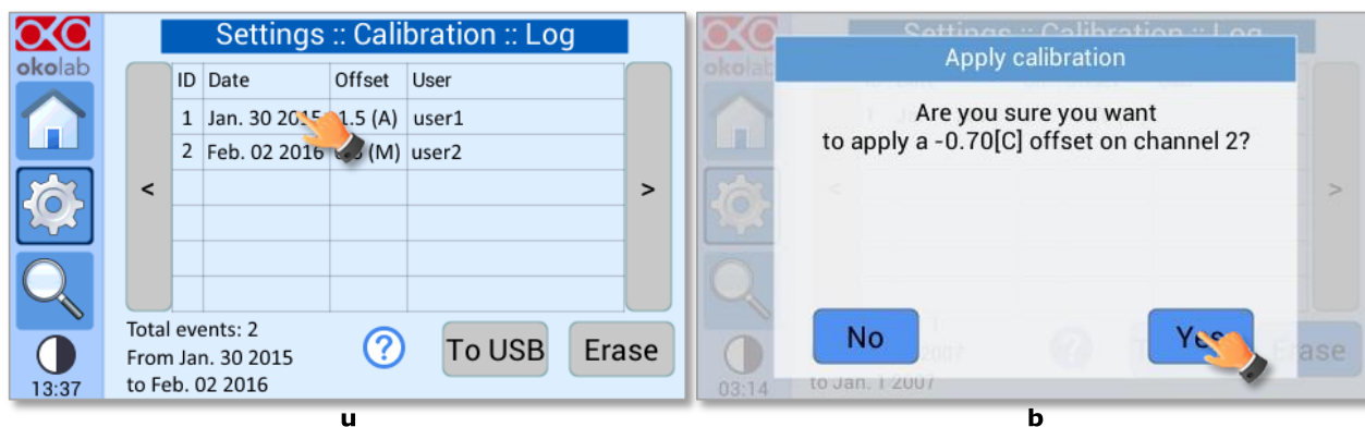
Figura 45. Come applicare una calibrazione precedente
