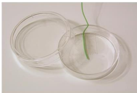
Figure 32. Capteur T fixé à l'intérieur d'une boîte de Petri de 35 mm
