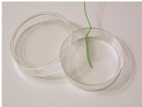
Εικόνα 32. Αισθητήρας T ασφαλισμένος μέσα σε ένα τρυβλίο Petri 35mm
