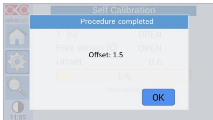
Εικόνα 38. Παράδειγμα επιτυχημένης διαδικασίας αυτοβαθμονόμησης
