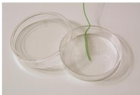
Фигура 32. Т сензор, закрепен в 35 mm петриево блюдо
