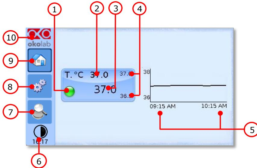
Figure 9. Homepage of the H201-T-UNIT-BL Controller Touch Screen Display
